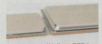
Ryzen Threadripper (右) 的 PCB 基板較 Ryzen (左) 厚，以及裝上高身金屬散熱蓋。
