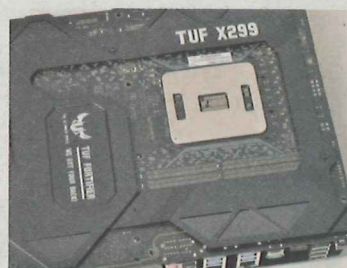
底部散熱片 「TUF Frontier」鋁製 Heat Spreader 約厚 1mm，令不同區域的熱力能平均排走。
