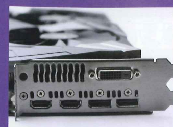
●雙HDMI 2.0設計方便接駁多個VR裝置，另有雙DisplayPort 1.4及一個DVI顯示輸出。
