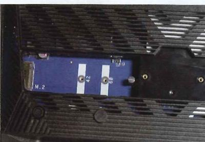
● 拆開機底可見到M.2 2280插槽。
