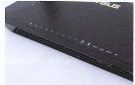
● 機面設有一整排顯示燈，清楚顯示運作狀態。
