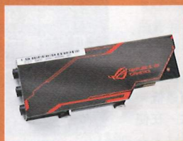
PART 05 HD-Audio 音效子卡 ROG SupremeFX Impact III 音效子卡，外部加上金屬外殼作為屏蔽。
