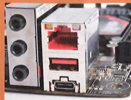
PART 04 USB 3.1 接埠 背板提供 USB 3.1 的 Type-A 及 Type-C 接埠各 1 個，上方則為 Intel I219-V Gigabit LAN 網路插座。
