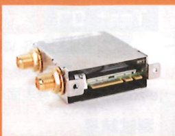
PART 02 無線網路模組 Wi-Fi 天線插座內藏 IEEE 802.11ac Wi-Fi 及 Bluetooth 4.1 模組，並以 M.2 介面接駁到主機板。
