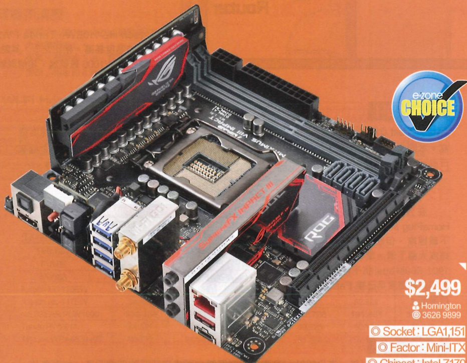
PART 05 HD-Audio 音效子卡 ROG SupremeFX Impact III 音效子卡，外部加上金屬外殼作為屏蔽。
