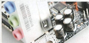
音效供電同樣採用 ELNA 音效電容。
