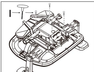
▲ 圖為底盤螺絲拆卸處
