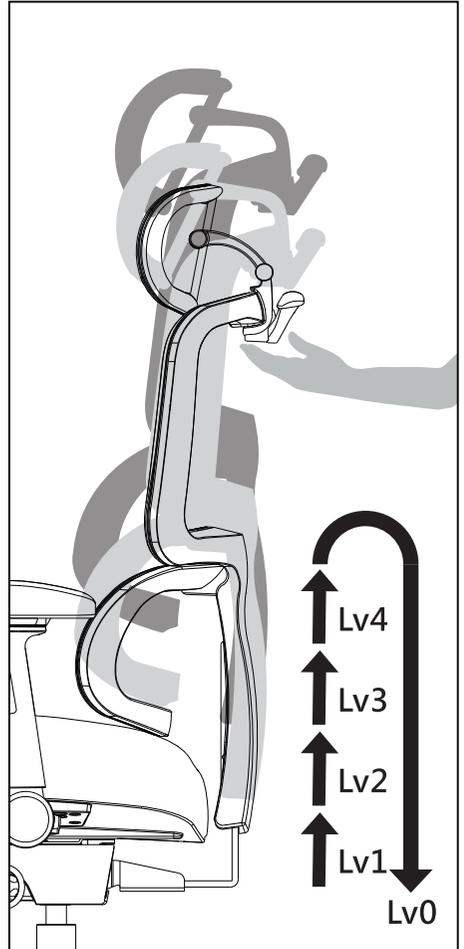
椅背可4段可向上拉伸調整高度，當調整到LV4最高點時再往上拉可降回至最LV0低點。
