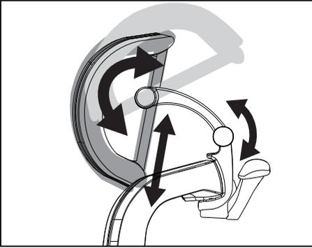
頭枕可以上下移動高度及角度調整到合適位置(角度無鎖定)。
