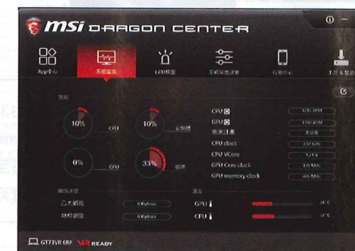
● MSI Dragon Center軟件提供齊全的運作狀態，包括CPU及GPU溫度、使用率、風扇轉速等。
