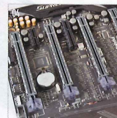
03 提供U.2和M.2 Socket 3。 04 PCI-E 2.0 x4和PCI-E 2.0 x1均為開放式設計。
