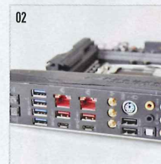
01 CPU部份設8相Extreme Engine Digi+供電。 02 提供雙Intel Gigabit LAN、雙USB-C連接。
