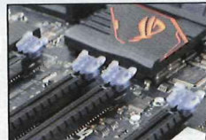
● PCI-E插槽末端換上透明膠扣。
